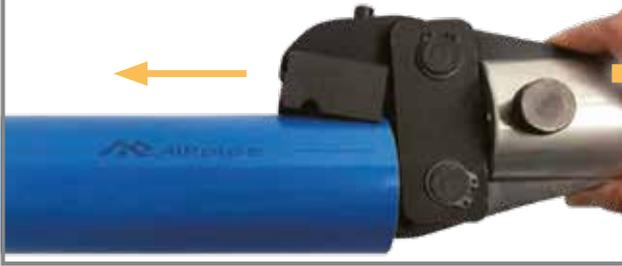
**2.** Lösen Sie die Pressbacken. Betätigen Sie den Schalter und bördeln Sie das Rohr, solange bis Sie ein Schlaggeräusch hören.
