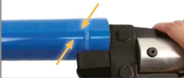
**3.** Öffnen Sie die beiden Pressbacken und entnehmen Sie das Rohr. Drehen Sie das Rohr zur angegebenen Position.
