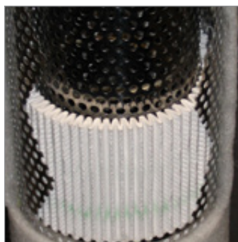
Standardmäßig gefaltete Konstruktion
