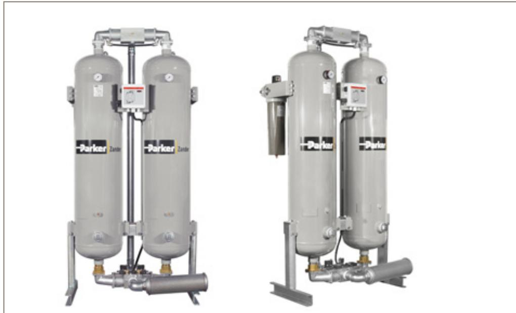
Die Adsorptionstrockner der Serie K-MT 35-95 arbeiten standardmäßig mit einem festen Wechselintervall zwischen den beiden Behältern. Falls ein Einsatz in Druckluftnetzen mit schwankendem Betriebsdruck und Abnahmemengen erforderlich ist, ist optional die Ausführung mit Taupunktmessung verfügbar: Hier erfolgt ein Wechsel zwischen den Behältern nach Bedarf. Erst wenn der erforder-
