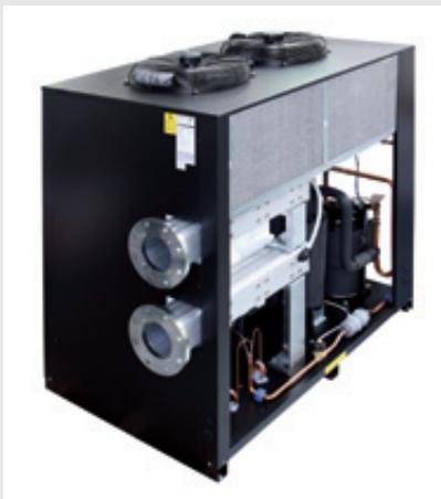
Für größere Trockner, wie das hier gezeigte Modell PoleStar Smart (PST 750), können mehrere Wärmetauscher zu einer kompakten Einheit zusammengefasst werden. Jede Einheit ist dabei mit einer speziellen Wärmeschild-Isolierung (basierend auf TSI-Polystrol) ausgestattet. Die Isolierung hält die Wärmeverluste gering und sorgt so für einen noch höheren Wirkungsgrad.
