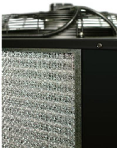
Luftgekühlte Verflüssiger sind mit Kupferrohren und Aluminiumlamellen ausgestattet, die von der Kühlluft angeströmt werden. Die Kühlluft wird dabei von einem (oder auch mehreren) Axialventilatoren erzeugt. In den PoleStar Smart Modellen PST120 und
