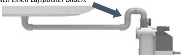
Das ½" Ablaufrohr soll idealerweise waagrecht installiert werden, oder abwärts geleitet werden ( $>1^\circ$ ).
