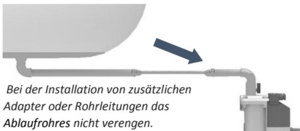
Bei der Installation von zusätzlichen Adapter oder Rohrleitungen das Ablaufrohres nicht verengen.
