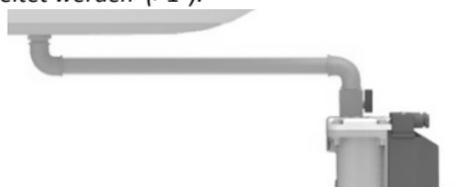
Wenn der Hang des Ablaufrohrs nach unten nicht ausreicht, oder wenn andere Kondensat-Strömungsprobleme entstehen, muss eine Entlüftungsleitung installiert werden sodass die Bildung eines Luftpolsters verhindert wird.
