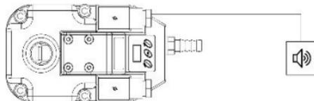
3. SchlieÙe das Alarmgerät auf einer passenden Stromversorgung an. Der Alarm ist eine 'potentiell freie Schaltung'. Eine externe Stromversorgung ist nötig weil der Alarm nur funktioniert wie einer Schaltung.
