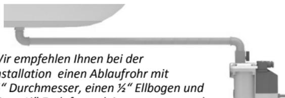
Wir empfehlen Ihnen bei der Installation ein Ablaufrohr mit ½" Durchmesser, ein ½" Ellbogen und ein ½" Entlüftungsleitung zu verwenden sodass die Bildung eines Luftpolsters verhindert wird.
