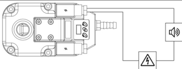
1. Entfernen Sie den Sicherheitsdeckel der Verbindung und verbinden Sie das Stromkabel wie unten ausgebildet.
