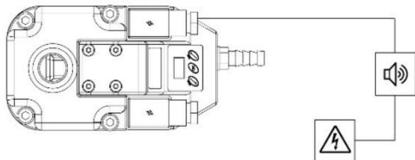
4. SchlieÙe die Stromversorgung auf den Alarmstecker der Kondensatableiter an um den Kreis zu schließen.
