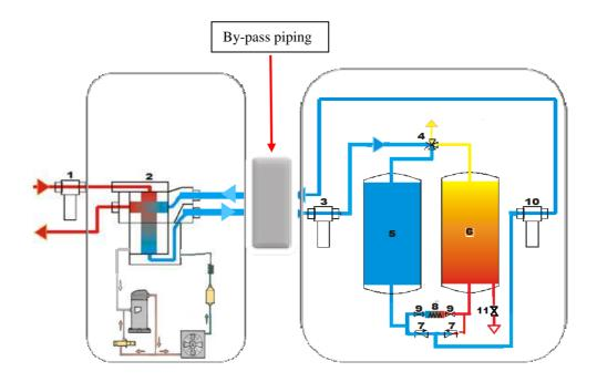
The by-pass is made by a pipe equipped with a solenoid valve. Il by-pass è costituito da una tubazione dotata di elettrovalvola.
