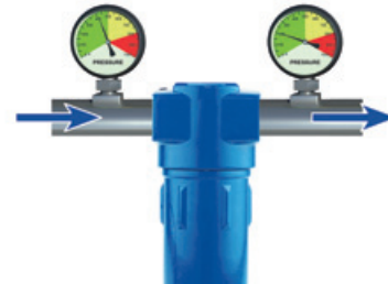
Druckwiderstand, wird auch als Differenzdruck (vor und nach Einbauten) bezeichnet
