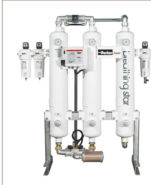
Die aufbereitete Druckluft gelangt auf die integrierte Reiniger-/Katalyststufe, die Öldampf, Gerüche, Gasanteile und Kohlenmonoxid zuverlässig entfernt. Abschließend gelangt die so aufbereitete Atemluft über den validierten Austrittsfilter der GL-Serie in das nachgeschaltete Druckluftnetz. Die Atemluft-Aufbereitungseinheiten der Serie BSP-MT 10-95 arbeiten standardmäßig mit einem festen Wechselintervall zwischen den beiden
