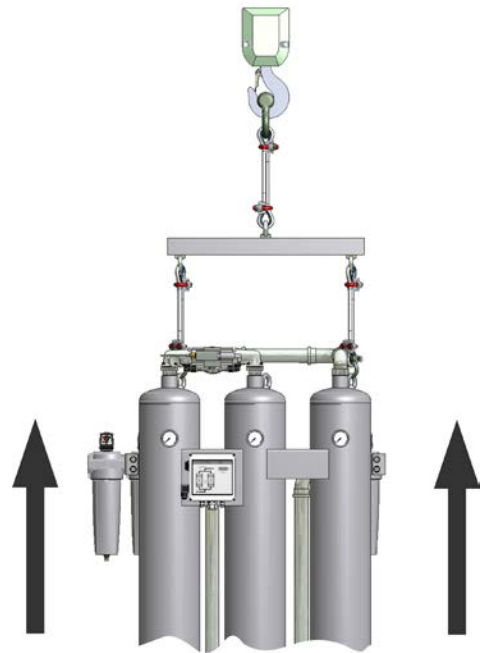
II: Aufstellen mit Kran
