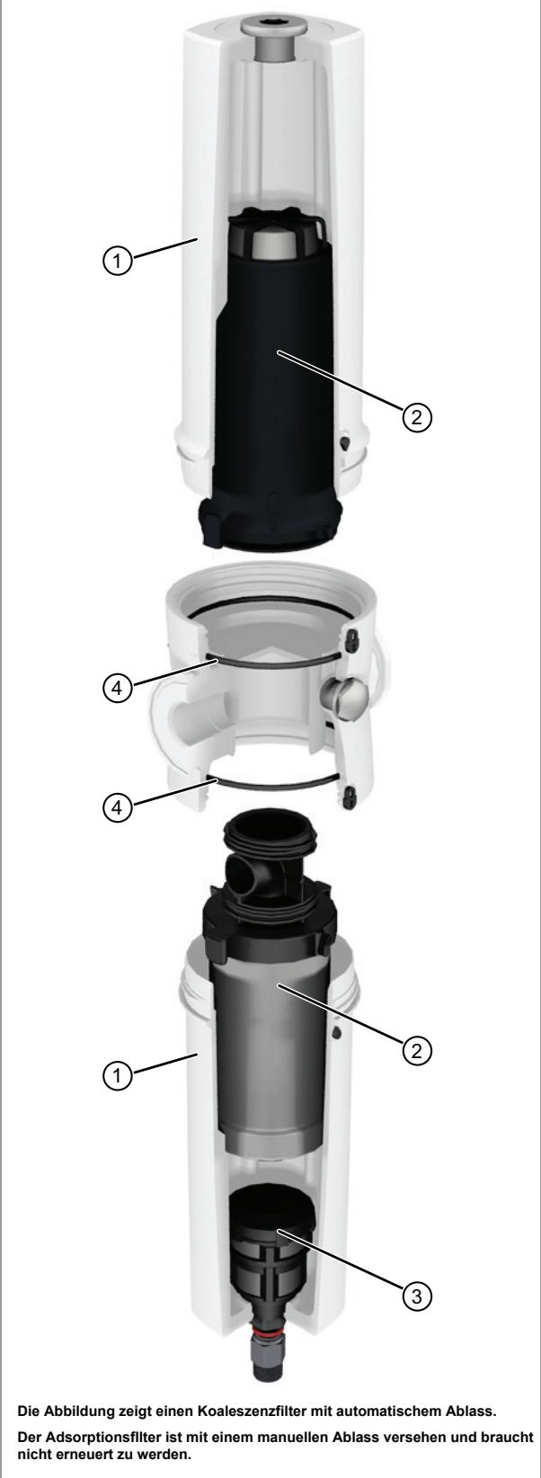
Die Abbildung zeigt einen Koaleszenzfilter mit automatischem Ablass. Der Adsorptionsfilter ist mit einem manuellen Ablass versehen und braucht nicht erneuert zu werden.
