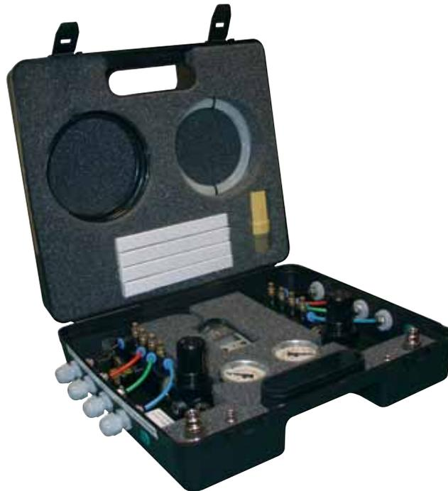
Der Prüfkoffer für Atemluftreinheit (APTK1) von Parker domnick hunter erlaubt die einfache Überprüfung der Druckluftqualität. Der Prüfkoffer ist kompakt und bedienerfreundlich. Eine Prüfung ist sowohl vor als auch hinter der Anwendung möglich.
