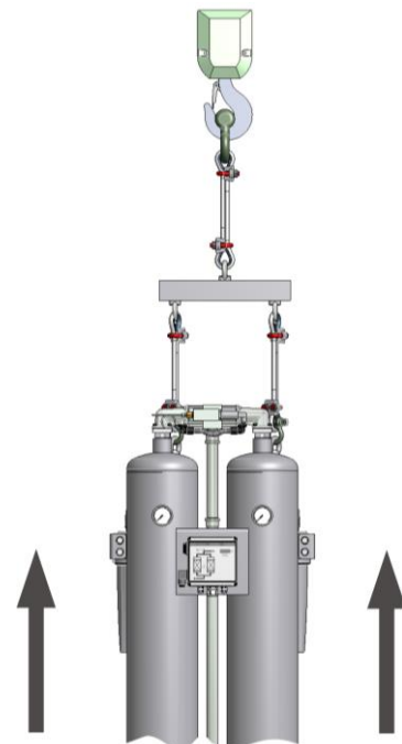
II: Aufstellen mit Kran
