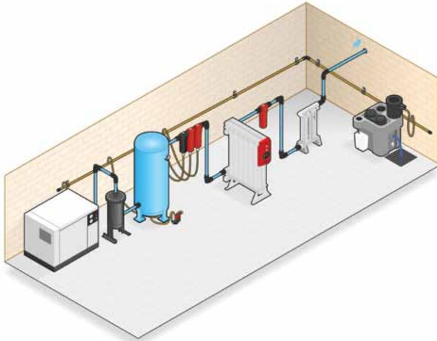
Wärmelose Adsorptionstrockner (auch als PSA-Trockner bezeichnet) sind die einfachste Bauform von Adsorptionstrocknern und seit langem für viele Branchen und Anwendungen die erste Wahl. Sie sind einfach, zuverlässig, kostengünstig und für Systeme mit geringem bis mittlerem Durchfluss geeignet.
