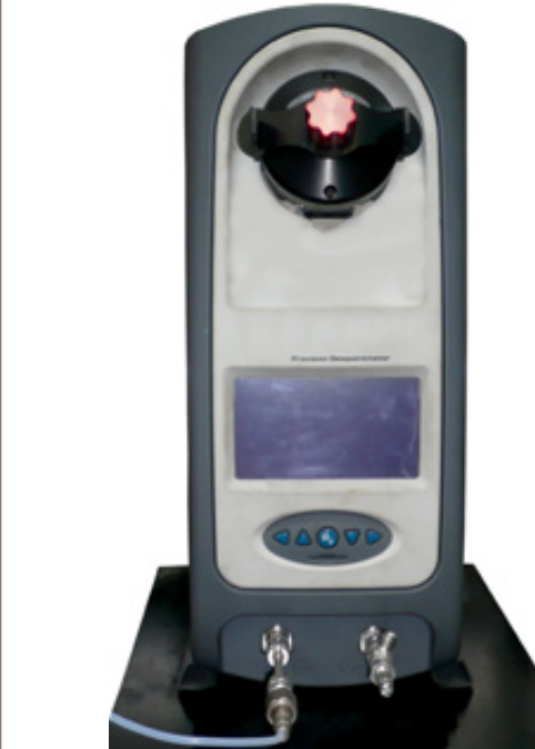
Beispiel eines gekühlten Spiegelhygrometers
