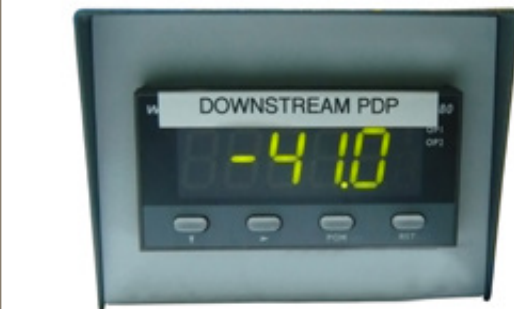
Beispiel eines typischen Hygrometers, das mit einer elektrischen Messmethode arbeitet (basierend auf Kapazität, Widerstand oder Leitfähigkeit)
