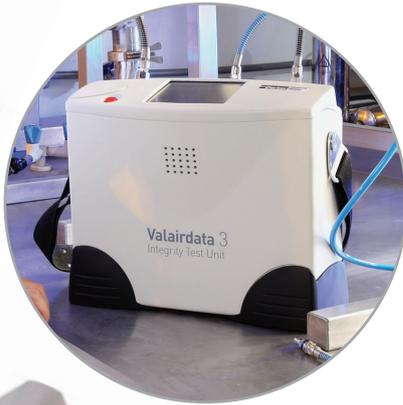
Das **schnellste** und **einfachste** Verfahren, um die **Integrität** von **Sterilgas**filtersystemen zu überprüfen.
