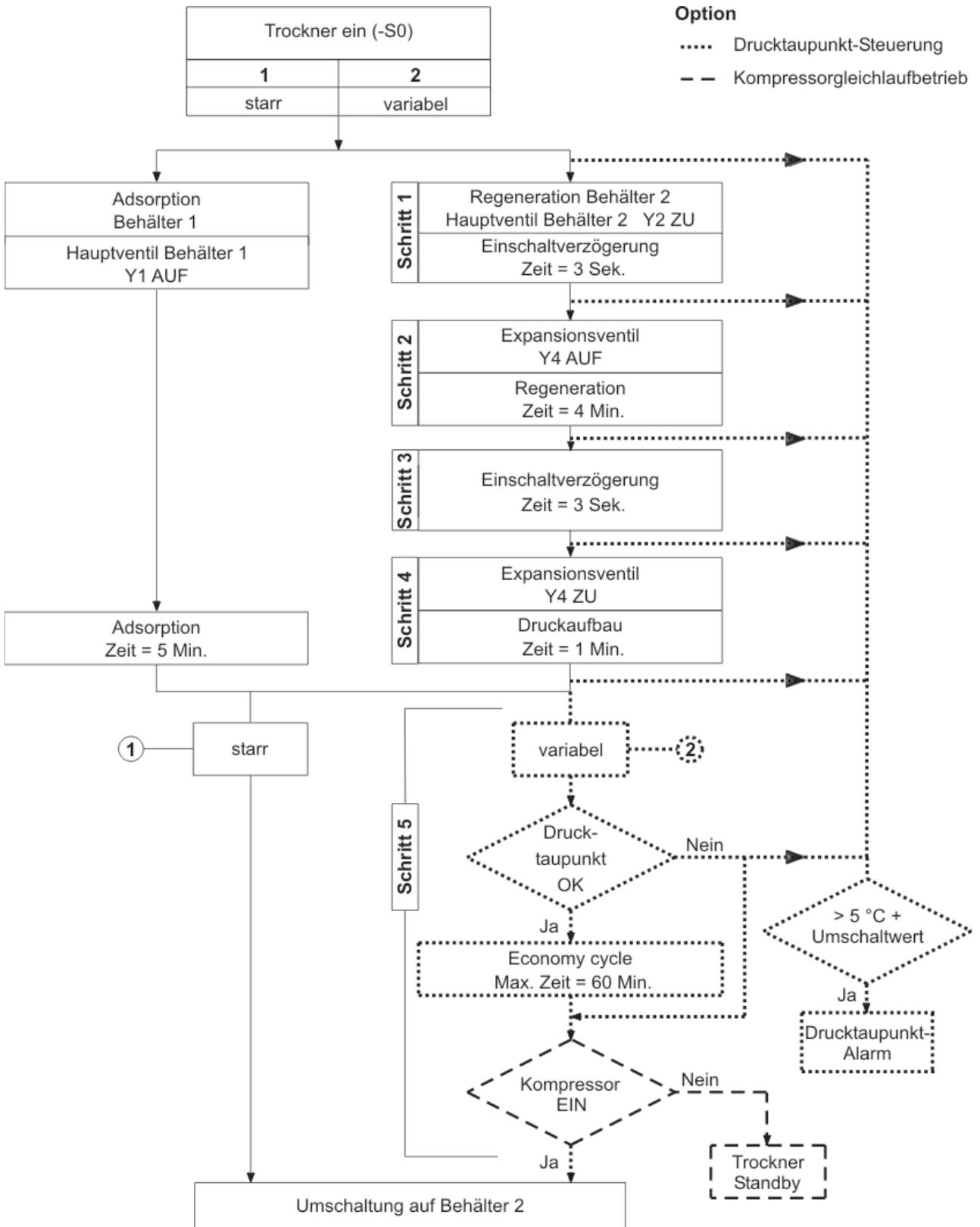
Regeneration in B1 und Adsorption in B2
