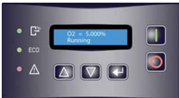
A–sterowanie z analizatorem O 2
