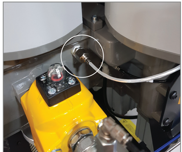
(d) OFAS / FBP Hygrometer 4mm PTFE hose connection
