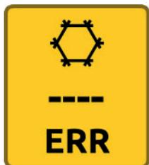
Sollte ein Fehler beim Parker Taupunktsensor (PDS) oder dem Taupunkthygrometer auftreten, erscheint ein gelbes Feld um das Taupunktsymbol. Der Wert des Taupunkts am Auslass wird durch „---“ ersetzt und „ERR“ wird angezeigt.
