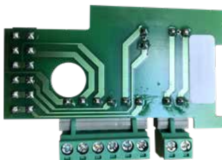
Aufsteckplatine Analogausgang 4-20 mA
