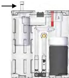
2. Das weiße Indikator-Element sinkt, sobald es gesättigt ist mit Öl. Der Element-Indikator dient also als Hinweis über den Sättigungsgrad des Weißen Indikator-Elements.
