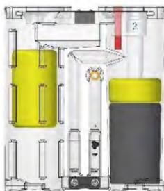
4. Der Rote Warnungs-überlauf Indikator steht Oben wenn der Wasserstand im Öl-Wasser-Trenner zu hoch kommt und Warnt das der Durchlauf des Kondensates im Trenners ernsthaft blockiert wird (z.B. Auslass ist Blockiert oder die Aktivkohle blockieren).
