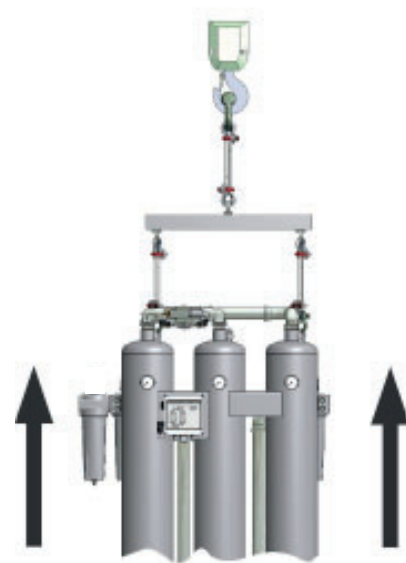
II: Aufstellen mit Kran
